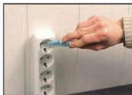
Для определения переменного напряжения прикоснитесь щупом тестера к одной из клемм розетки. Горящий светодиод указывает на то, что данная клемма является фазой. В противном случае «0».
