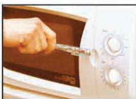
Поставьте в микроволновую печь емкость с одним литром воды или какие-нибудь продукты. Включите печь на одну минуту в максимальном режиме. Проведите тестером вокруг двери. В случае утечки загорится светодиод.
