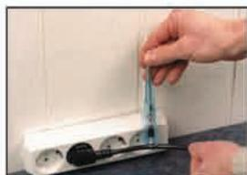
Для определения места обрыва в кабеле, свободной рукой возьмите провод и проведите прибором вдоль него. В месте, где светодиод погаснет, провод переломлен.
