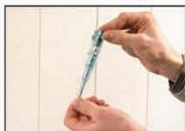
При проверке прибора необходимо прикоснуться одной рукой к кончику отвертки, а другой к пятачку. При нормальном функционировании загорится светодиод.
