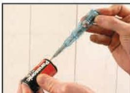
Чтобы определить полярность батареи, необходимо замкнуть указательным пальцем пятачок тестера и прикоснуться щупом к одной из клемм батареи. Второй рукой замкните другую клемму батареи. При прикосновении щупа к положительной «+» клемме загорится светодиод.
