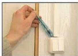
Поднесите тестер пятачком к силовому проводу, к розетке, к выключателю и т.д. Горящий светодиод укажет на наличие переменного напряжения в исследуемом объекте.
